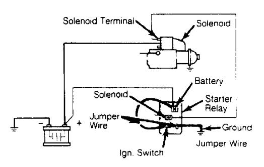
TESTING WITH 2 JUMPER WIRES
