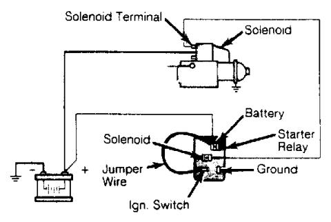
TESTING WITH ONE JUMPER WIRE
